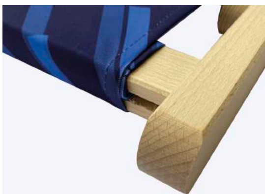
La toile se fixe à l'aide d'une baguette de bois dans la rainure puis enroulée autour de la structure pour un maximum de sécurité.
